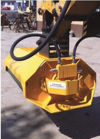
Nuestra serie DB utiliza el mismo rotor de la serie NS. Esto le permite triturar ramas o arbustos de hasta 8-10 cm. eEstan equipadas con cuchillas en forma de "Y". Más una tercera cuchilla central que permite demoler finamente.
